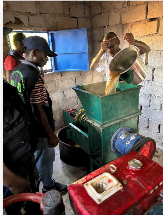
Motorbetriebene Palmfruchtquetschmühlen erleichtern die Verarbeitung größerer Erntemengen erheblich.
